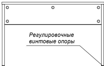
11. Установите собранный стол на место, с помощью регулировочных винтовых опор выставите устойчивое положение.
