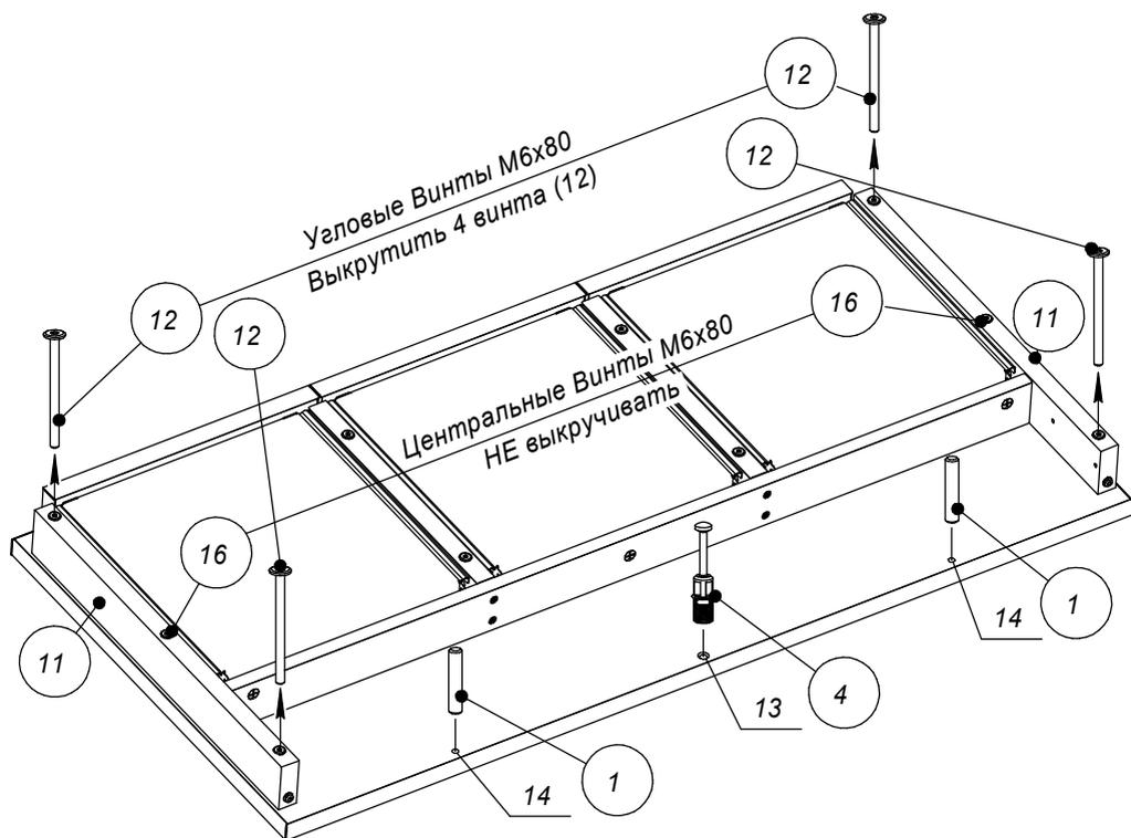
3. Полностью выкрутите четыре Винта (12) расположенные по углам столешницы, этими винтами (12) будут прикручиваться боковые опоры (7).
