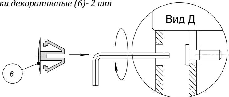
Схема крепления столешницы к подстолью
